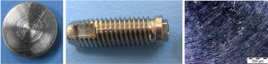
Imágenes de los implantes de Titanio utilizados y estructura superficial observada mediante Microscopía óptica
