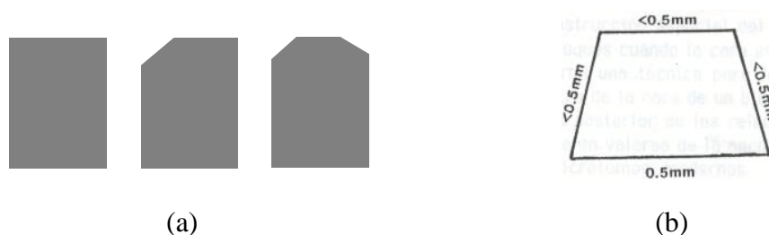
Figura 4. Tallado o formación de la pirámide truncada del bloque: (a) vista longitudinal, (b) vista transversal.
