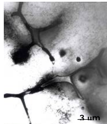
Fig. 6. Fotomicrografía por MET de una muestra del AISI 304L en la ZF. Se observa una matriz austenítica con ferrita delta y precipitados angulares en el seno de la matriz.
